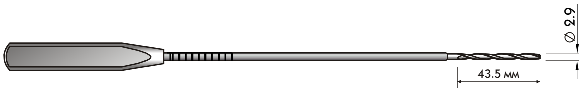
Сверло канюлированное (Титан. сплав, нерж. сталь)
