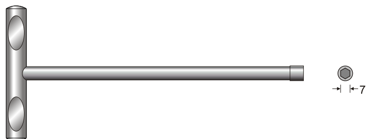
Ключ торцевой (Титан. сплав)
